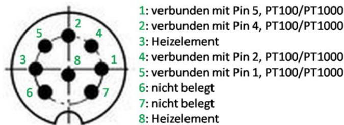
**Abbildung 4-3:** Stecker und Pinbelegung der Heizeinheit für die Verwendung mit dem Temperaturkontroller TC1010 der Firma mb-Technologies;
