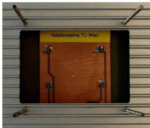
**Abbildung 3-8:** Gehäuseoberseite mit Ausfräsung und fest verbauter Basisadapterplatine; Adapterplatine für Pinbelegungswahl wird von oben eingesteckt, siehe Abbildung 7-2; M3 Gewindestangen dienen als Positionshalter der aufsteckbaren Heizeinheit, siehe Abbildung 7-3;
