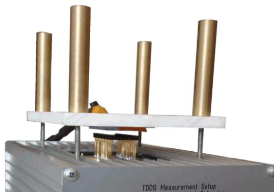
**Abbildung 4-2:** CME Vorderansicht mit aufgesteckter Heizeinheit; Madenschrauben legen den maximalen Tiefgang fest, sodass das Heizelement nicht auf den IC-Sockel anfährt;
